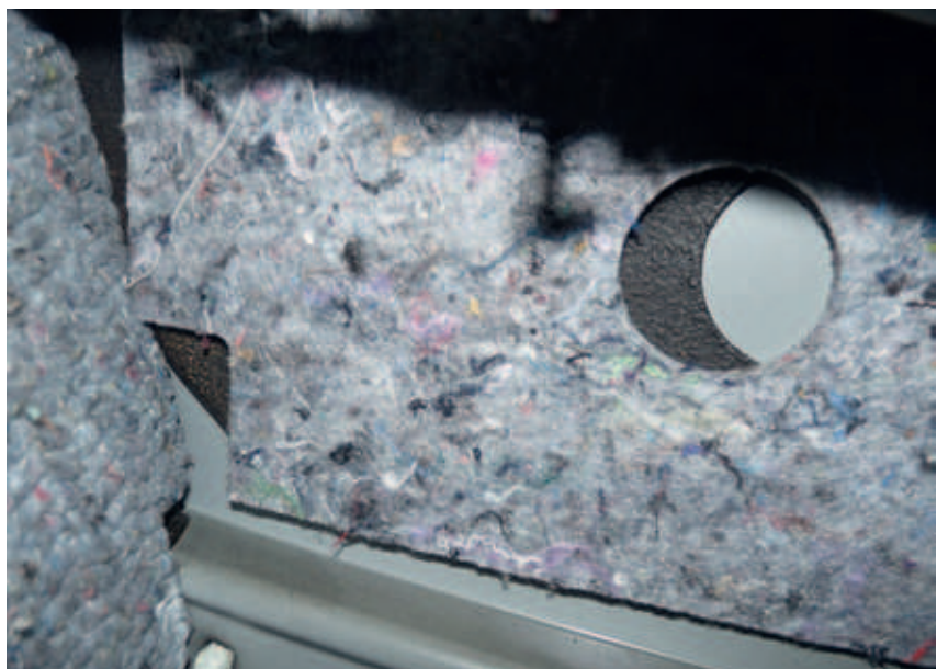
Eindproduct met afvalpoeder: akoestisch vormdeel in autobouwtolpassing
