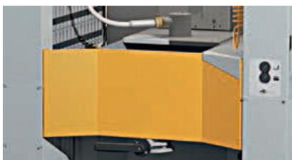
a un contenu de 60 litres. Il est conçu pour travailler avec des pompes AP01 15/30. Les tubes d'aspiration courts et l'ouverture/fermeture rapide des pistolets représentent également un avantage. Le réservoir garantit un niveau constant du volume de poudre ainsi qu'une vidange et un nettoyage aisés.
