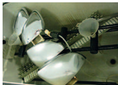
* Figuur 3 ABS gemetalliseerd met micro-poreus Ni/Cr (glanzend en satijn) voor 100h vergelijkende CASS test.
