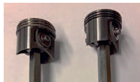
Illustration 5: pistons réalisés par fabrication additive et revêtus d'un film mince lubrifiant élaboré par procédé PVD ▲
