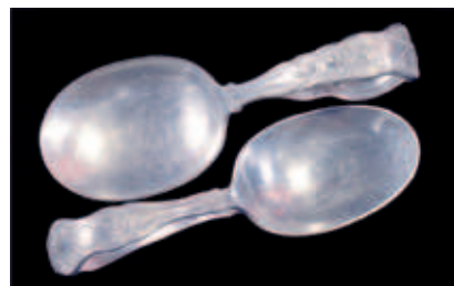
Afbeelding 1: aangeslagen zilver. De kleur van de aanslag kan gelijkmatig verdeeld zijn of als vlekken optreden.
