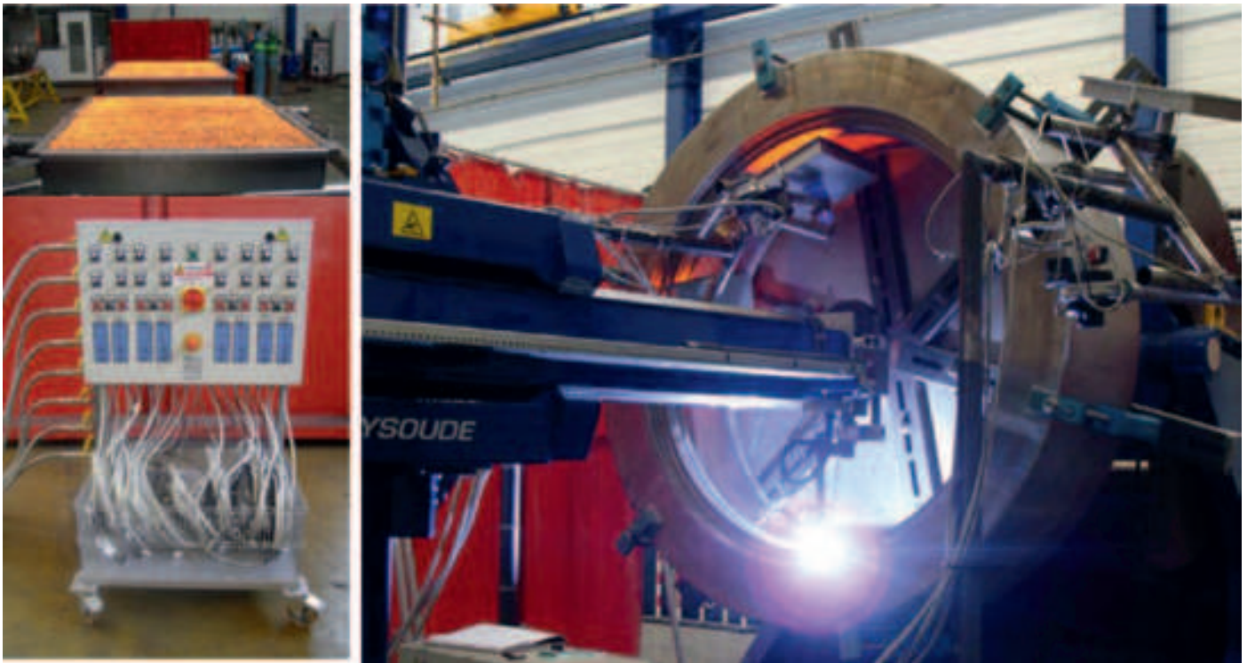
Photo 5 : utilisation des MFB pour le préchauffage d'Inox (150°C) avant rechargement d'Inconel par plasma.
