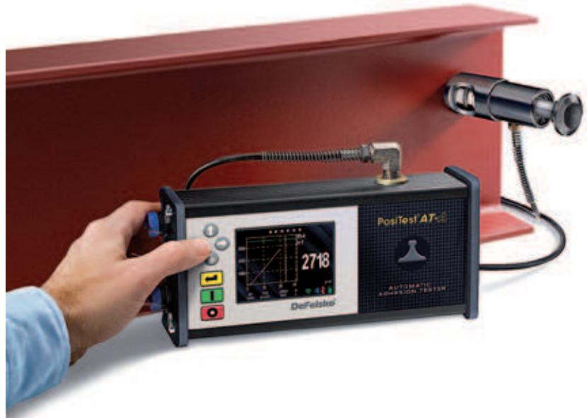
Bij een pull off test wordt de spanning loodrecht op het te testen oppervlak afgestemd en toegepast.
