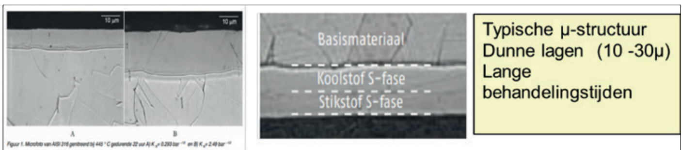
Figuur 7 Schematisch overzicht, N & N/C, typische microstructuur, na-oxidatie
