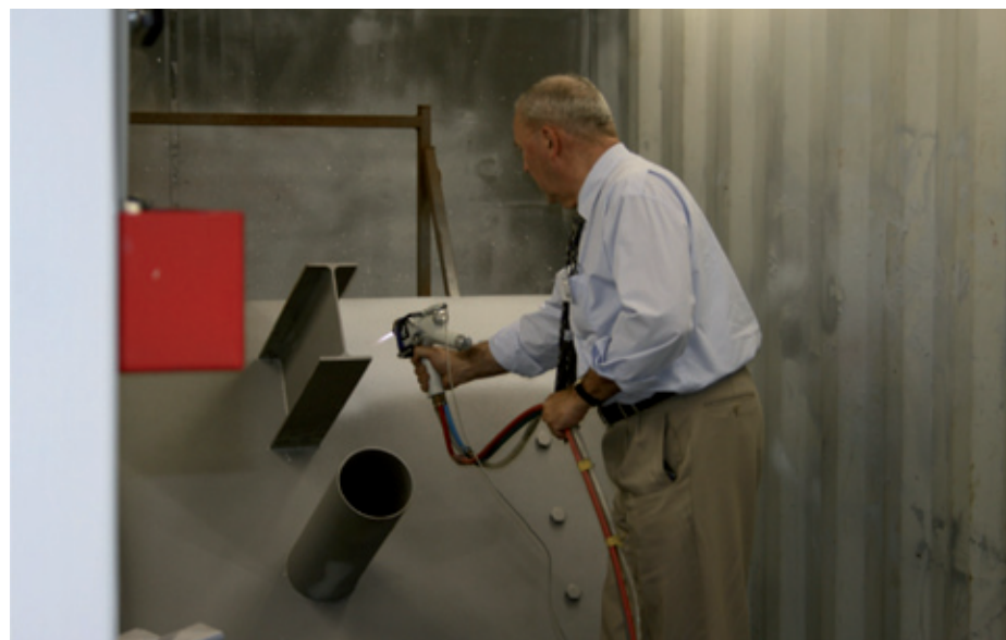
▲ Georges Thielman geeft een demo metallisatie bij Pigment-Forem te Strépy.
