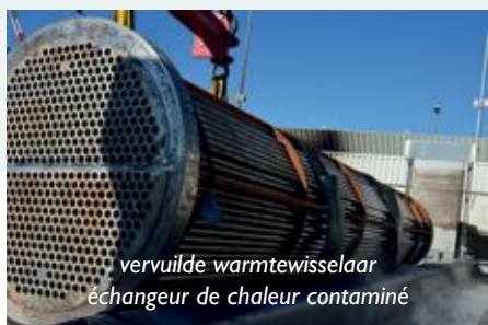
het reinigen van een warmtewisselaar via ultrasoon le nettoyage d'un échangeur de chaleur par ultrasons
