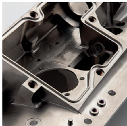
Photo 2. Pièce complexe nickelée chimiquement
