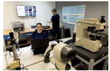
Figuur 5. Metrologische inspectie van laagdikte en hardheid voor kwaliteitsborging.
