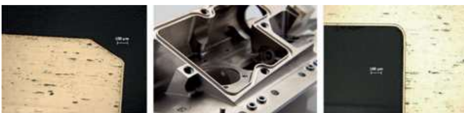
Figuur 1. Chemisch vernikkelde onderdeel (midden) met uniforme laagdikte, zonder randeffecten (links en rechts) – typisch resultaat van een auto katalytisch proces.
