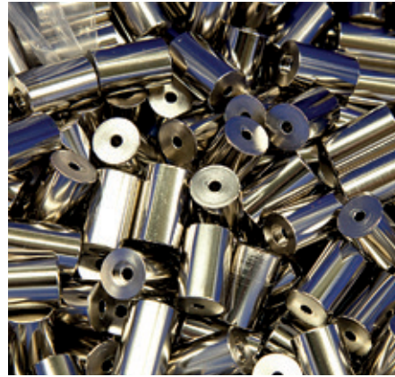
Foto 5. Chemisch hard vernikkeld onderdeel
