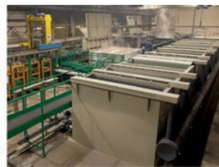
Figuur 4. Volautomatische vernikkelingslijn met strikte procesbewaking — sleutel tot reproduceerbaarheid en Additieve manufacturing en prototyping ondersteunen designoptimalisatie voor vernikkelde componenten.
