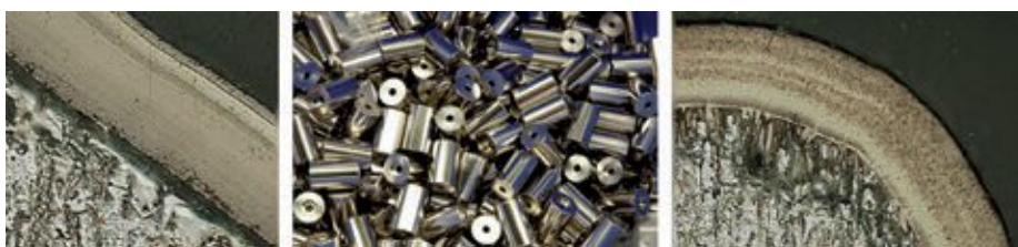
Figuur 2. Doorsnedes van chemisch nikkel zoals neergeslagen (lamellaire structuur) en na harden op 280 °C (de lamellaire structuur verdwijnt). Een gelijkmatige, gesloten interface bevordert de hechting.
