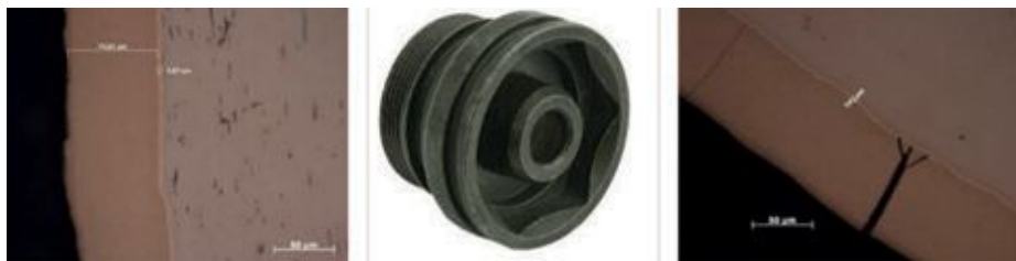
Figuur 3. Doorsnede van diffusie chemisch nikkel: witte overgangszone zichtbaar tussen substraat en Ni-P-toplaag. (Midden) In lucht behandelde (zonder schutgas te gebruiken) diffusie laag met kaki-groene tint, typisch voor petrochemische specificaties.
