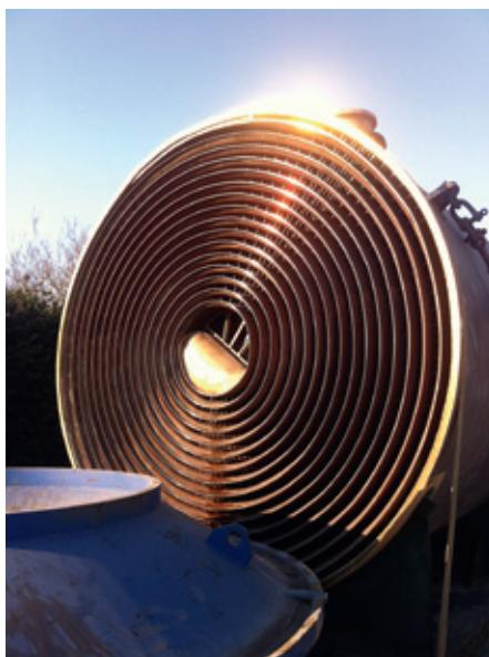
strikt programma gereguleerd om geen spanningen in het metaal op te bouwen. Voor speciale staalsoorten zoals bijvoorbeeld Duplex kunnen we, als de vervuiling dit toelaat, ook lagere temperaturen gebruiken. In dat geval kraken we de aanwezige vervuiling om ervoor te zorgen dat deze eenvoudiger te verwijderen is met hoge druk reiniging.
