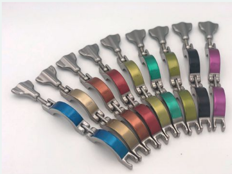
▲ Échantillon du panel de couleurs obtenues par revêtement sol-gel
