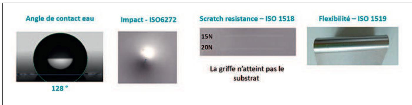
Figure 3: tests sur sol-gel hydrophobe
