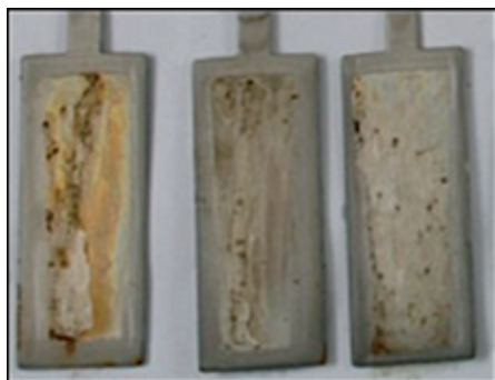
Figure 5: Dépôts de NiW élaborés par électrodéposition après exposition de 1000 heures au brouillard salin
