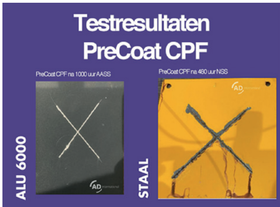
▲ De resultaten na 1000 uur AASS conform DIN EN ISO 9227 uitgevoerd door IFO en 480 uur NSS op staal.
