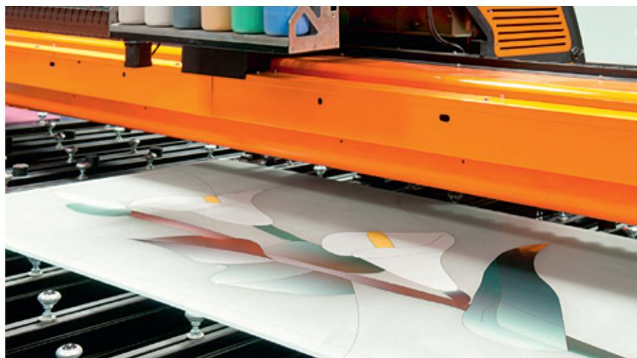
▲ L'impression s'effectue via le principe du jet d'encre et est entièrement contrôlée par CNC. L'impression se fait en un seul passage, ce qui permet un gain de temps et de matériel important.
