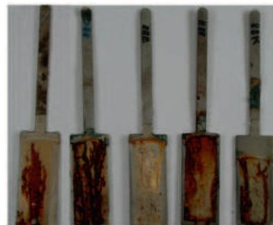
Figure 5: a) Spectre DRX; b) photo après 96 h de brouillard salin de dépôts NiW pour différentes densités de courant.
