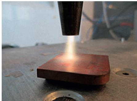
Figure 1: Torche plasma d'air sur substrat de cuivre
