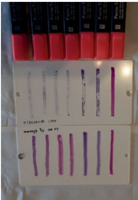
boven: Test inkten: 34-36-38-40-42-44-46 mN/m midden: Zonder plasmabehandeling. Enkel 34 mN/m inkt hecht goed aan het oppervlak onder: Na plasmabehandeling. Alle inkten hechten goed aan het oppervlak
