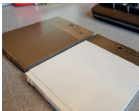
Figuur 5: Foto van een vernislaag en keramisch verf op een Invar stuk na glijlijpen.
