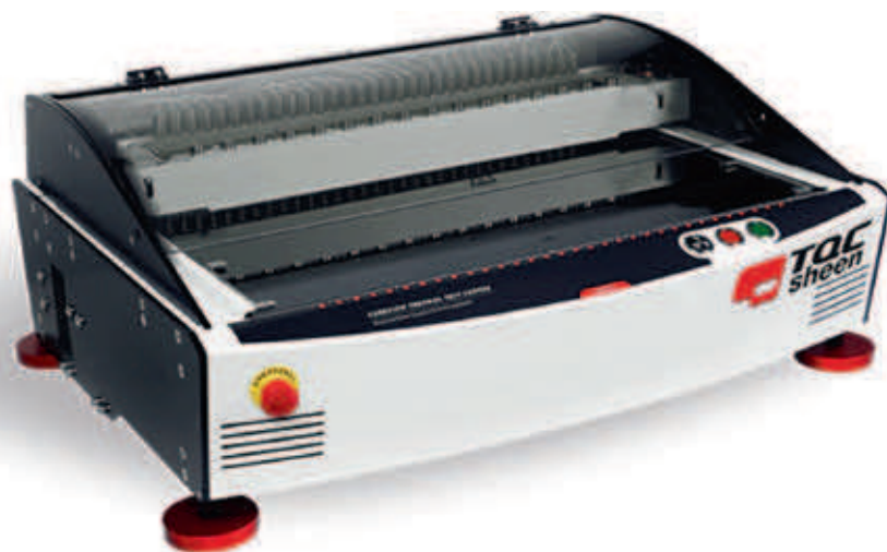
Dankzij de 32 individueel regelbare infrarood verwarmingselementen van de CureView kunnen coatings, grondstoffen en chemicaliën in één keer op verschillende temperaturniveaus worden getest.
