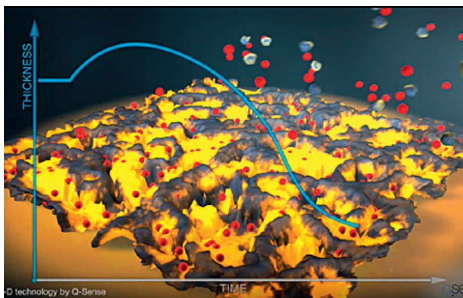
Fig. 1. Simulatie van het oppervlak van een gecoat QCM-kristal dat opgelost wordt door een vloeistof (solvent of surfactantoplossing) die er over heen stroomt. De grafiek geeft de verandering in laagdikte weer (aanvankelijk zwellen, nadien oplossen) van de model-coating.
