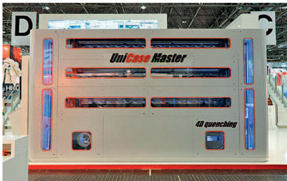
Zijaanzicht van de UniCase Master bandcarboneeroven voor stalen onderdelen met de 3 horizontale kamers en 2 zijdelingse liften
