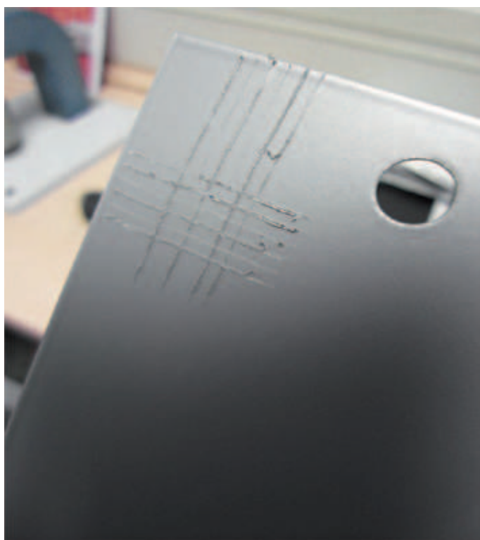
Impact- en hechtingstesten na behandeling met EskaphorZ2000 C en Eskaphor P400 NR
