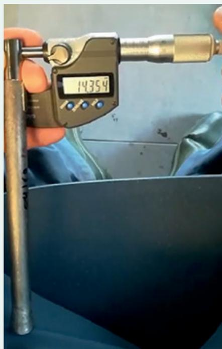
Ensuite, la démarche est affinée par une mesure de vitesse d'attaque effective du bain par mesure sur coupon témoin : l'objectif est ici sur base d'une pièce témoin de valider la vitesse d'attaque du bain et de déterminer les temps de traitement nécessaires à l'enlèvement matière souhaitée sur la pièce.
