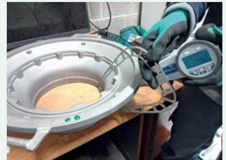
On peut ainsi obtenir en fin de traitement une pièce usinée chimiquement de manière homogène et avec une précision impressionnante !
