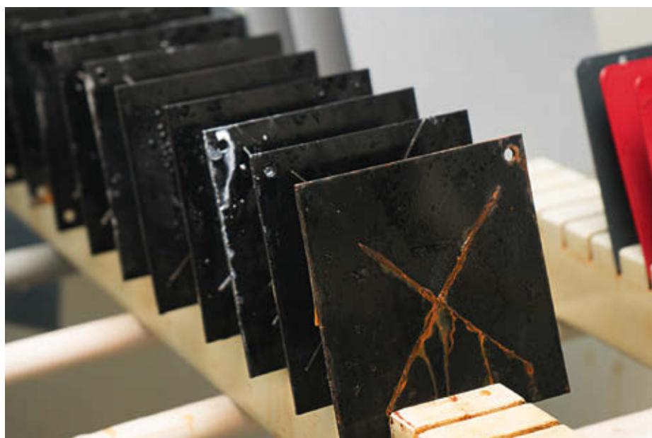
▲ Zoutsproeitest: testplaatjes in de zoutneveltest
