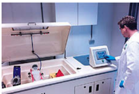
▲ voorbeeld van een cyclische corrosietest
