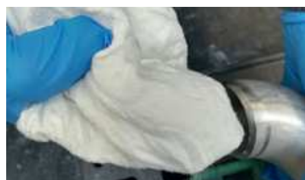
▲ Test au chiffon conforme (absence de coloration)
