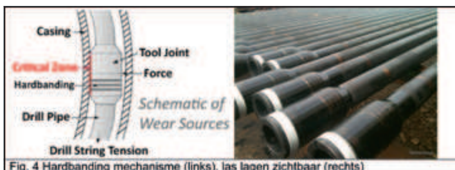
Fig. 4 Hardbanding mechanisme (links), las lagen zichtbaar (rechts)
