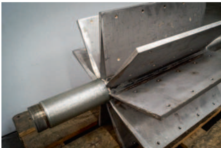
▲ Fig 1. Herstellen van de as tappen van een doseersluis: corrosiebestendig & slijtvast
