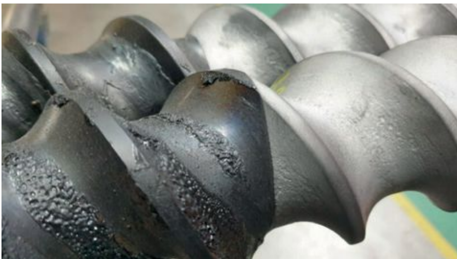
▲ Laser cleanen van plastic resten op extrusie schroeven van spuitgietmachines
