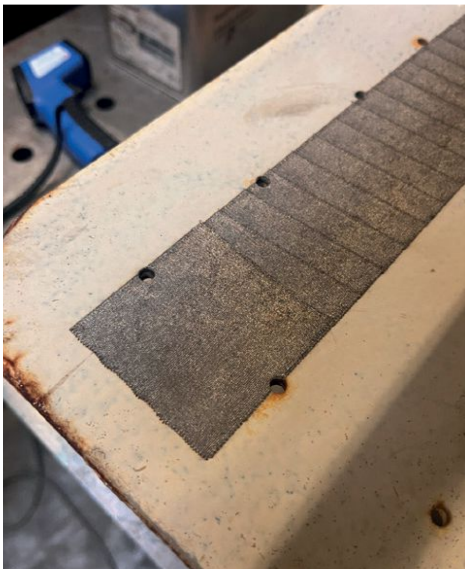
▲ Ruwheidsprofiel aangebracht door laser profiling
