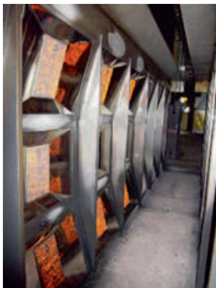
Poederlaklijn met infrarood insmeltzone met retrofit metaalvezelbranders, links laag vermogen rechts hoger vermogen
