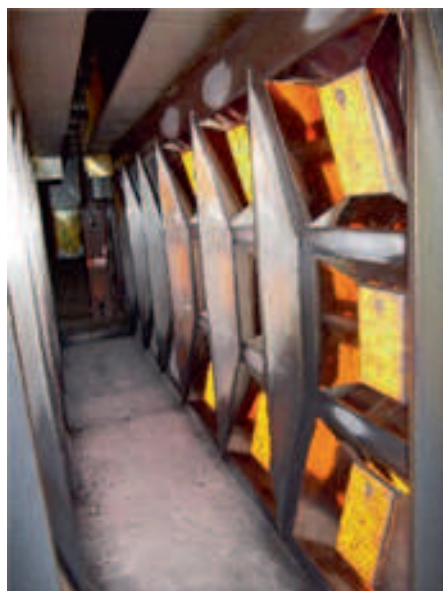
Poederlaklijn met infrarood insmeltzone met retrofit metaalvezelbranders, links laag vermogen rechts hoger vermogen
