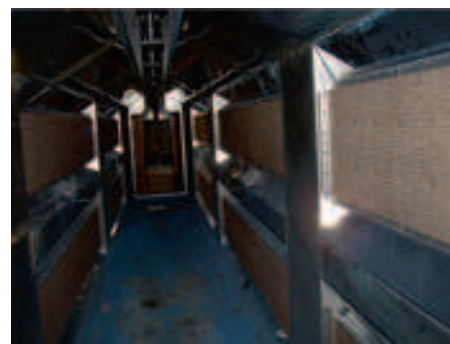
Nieuwe oven met op maat gemaakte infrarood stralende metaalvezel branders, alternerend aan en uitgeschakeld.
