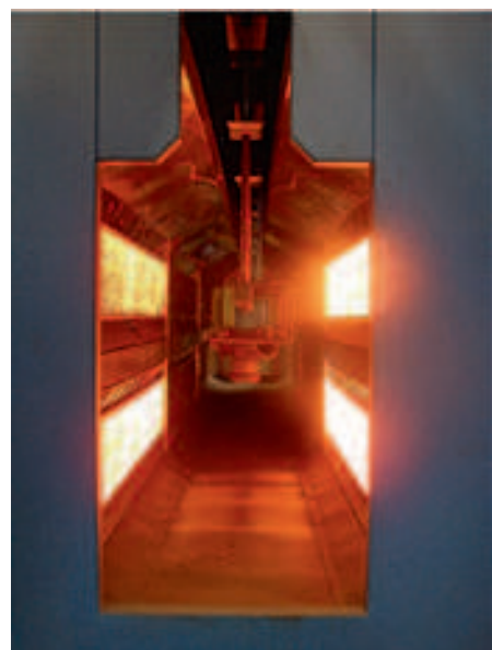
Poederlaklijn met infrarood insmeltzone met retrofit metaalvezelbranders, links laag vermogen rechts hoger vermogen
