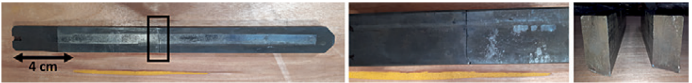
Photo 1: Rail en acier X210Cr12 trempé/revenu fissuré
