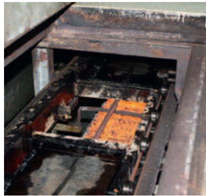
Afbeelding 9: links: de operator ontsteekt de conventionele branders met een toorts; rechts: de infrarood stralende metaalvezel gasbrander onder de gietijzeren vormen.
