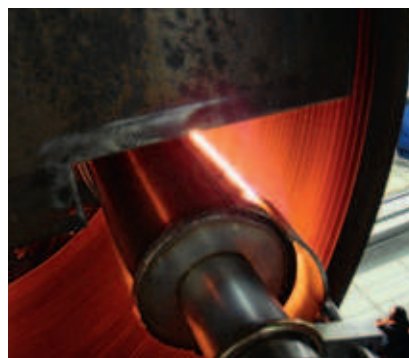
Afbeelding 10: links: de industriële continu-pannenkoeken lijn (de deeg wordt bovenop de verwarmde rol gegoten en bakt uit over een derde van de omloop); rechts boven: de conventionele branders die met de convectie van de hete vlam op de rol verwarmen; rechts onder: de veel energiezuinigere en flexibelere oplossing met infrarood stralende metaalvezel gasbranders.
