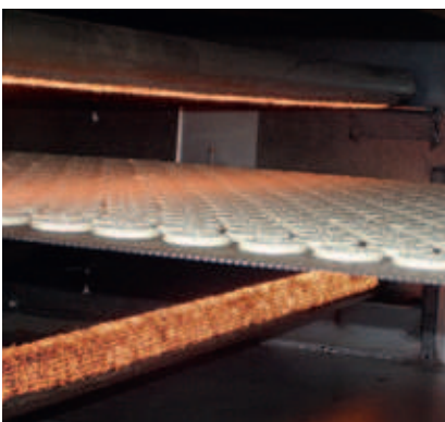
Afbeelding 2: links: infrarood stralende metaalvezel gasbranders in een continue bakoven ter vervanging van conventionele convectie ribbon burners; rechts: infrarood stralende metaalvezel gasbranders ter vervanging van elektrisch infrarood voor het flambere van eiwit topping.
