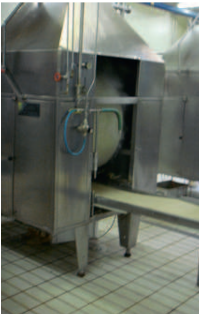
Afbeelding 10: links: de industriële continu-pannenkoeken lijn (de deeg wordt bovenop de verwarmde rol gegoten en bakt uit over een derde van de omloop); rechts boven: de conventionele branders die met de convectie van de hete vlam op de rol verwarmen; rechts onder: de veel energiezuinigere en flexibelere oplossing met infrarood stralende metaalvezel gasbranders.
