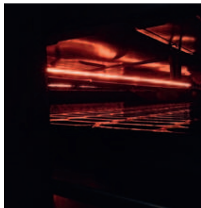
Afbeelding 7: links: de doorloopoven met volle transportband met de zachte cakejes; rechts: detailopname van de smalle strook metaalvezel materiaal op de buisbrander met een extreem laag vermogen per lopende meter, vanaf slechts 2.5 kW/m.
