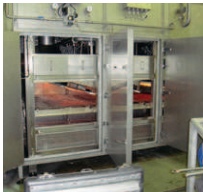
Afbeelding 5: infrarood stralende metaalvezel gasbranders in een industriële pizza lijn voor het aansmelten van de geraspte kaas vooraleer de pizza's te verpakken en in te vriezen.
