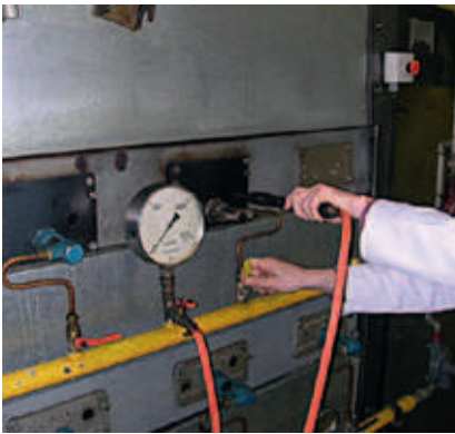
Afbeelding 3: links: manueel ontsteken van gasbranders in de oven – geen controle op de vlam of veiligheid bij ontsteking; rechts: de ribbon burner met gedeeltelijke primaire verbrandingslucht – slechte verbranding en hoge uitstoot van schadelijke stoffen.
