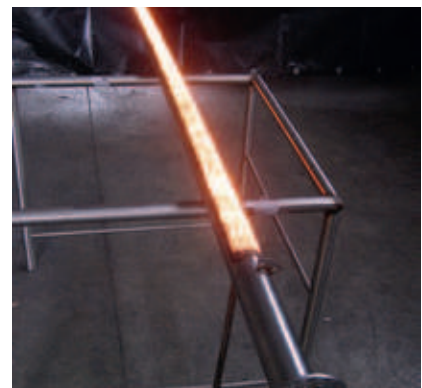
Afbeelding 8: links: de broden in hun bakvorm; midden: de infrarood stralende metaalvezel gasbranders in de oven; rechts: de gasbrander tot 4 meter lang.
