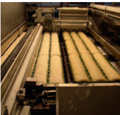
Afbeelding 8: links: de broden in hun bakvorm; midden: de infrarood stralende metaalvezel gasbranders in de oven; rechts: de gasbrander tot 4 meter lang.
