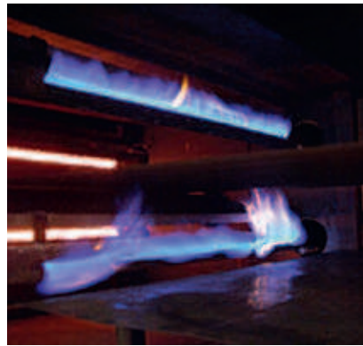
Afbeelding 6: links: de conventionele ribbon burners in de tunnel oven, op de achtergrond de reeds vervangen branders; rechts: de perfect ingestelde en afgeregelde infrarood stralende metaalvezel gasbranders ter vervanging van conventionele convectie ribbon burners.
