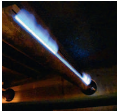
Afbeelding 3: links: manueel ontsteken van gasbranders in de oven – geen controle op de vlam of veiligheid bij ontsteking; rechts: de ribbon burner met gedeeltelijke primaire verbrandingslucht – slechte verbranding en hoge uitstoot van schadelijke stoffen.
