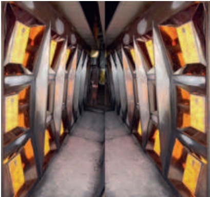
Afbeelding 1: links: infrarood stralende metaalvezel gasbranders ter vervanging van katalytische stralers; rechts: op maat gemaakte infrarood stralende metaalvezel gasbranders voor een nieuwe infrarood oven.
