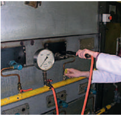
Afbeelding 9: links: de operator ontsteekt de conventionele branders met een toorts; rechts: de infrarood stralende metaalvezel gasbrander onder de gietijzeren vormen.
