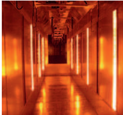
Afbeelding 1: links: infrarood stralende metaalvezel gasbranders ter vervanging van katalytische stralers; rechts: op maat gemaakte infrarood stralende metaalvezel gasbranders voor een nieuwe infrarood oven.
