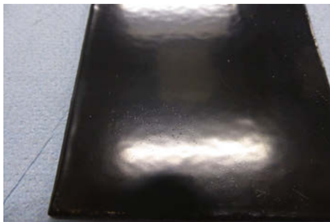
▲ Blistering na de kooktest voor Qualisteelcoat is reden voor afkeur
