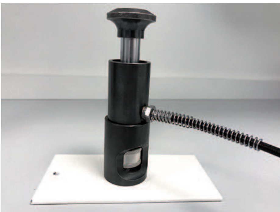
▲ Figuur 5: Toestel voor testen met loodrechte tractie (ISO 4624)
