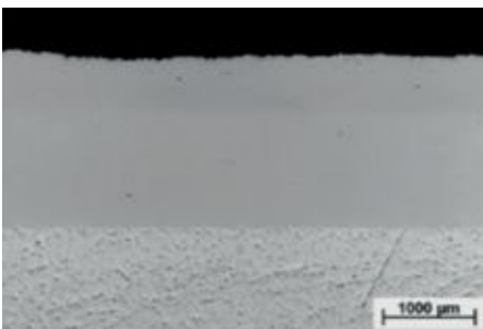
Metallurgisch foto van gespoten laag
