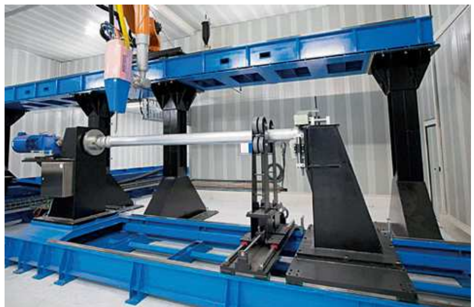
▲ Grootste 3D metaalprinter ter wereld met behulp van 3D-printing Cold Spray
