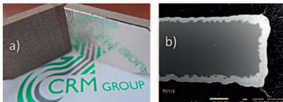
Fig. 1: a) photo comparant l'état de surface d'une pièce additive manufacturing en invar avant et après l'ajout d'un revêtement métallique de Ni lissant; b) micrographie en coupe montrant le caractère lissant du Ni.
