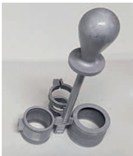
Fig. 4: photo d'une pièce d'aluminium additive manufacturing, polie par tribofinition et ensuite revêtue par une peinture céramique.
