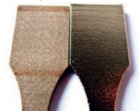
Figure 6: photo montrant l'état de surface d'une pièce additive manufacturing en invar avant et après l'ajout d'un revêtement métallique de Ni lissant.
