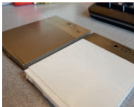
Figure 5: photo d'un vernis et d'une peinture céramique sur un substrat d'invar tribo-fini.
