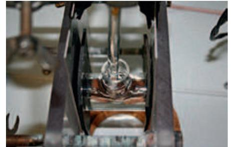
▲ *Figure 2 – Exemples de cellules électrochimiques à trois électrodes*
