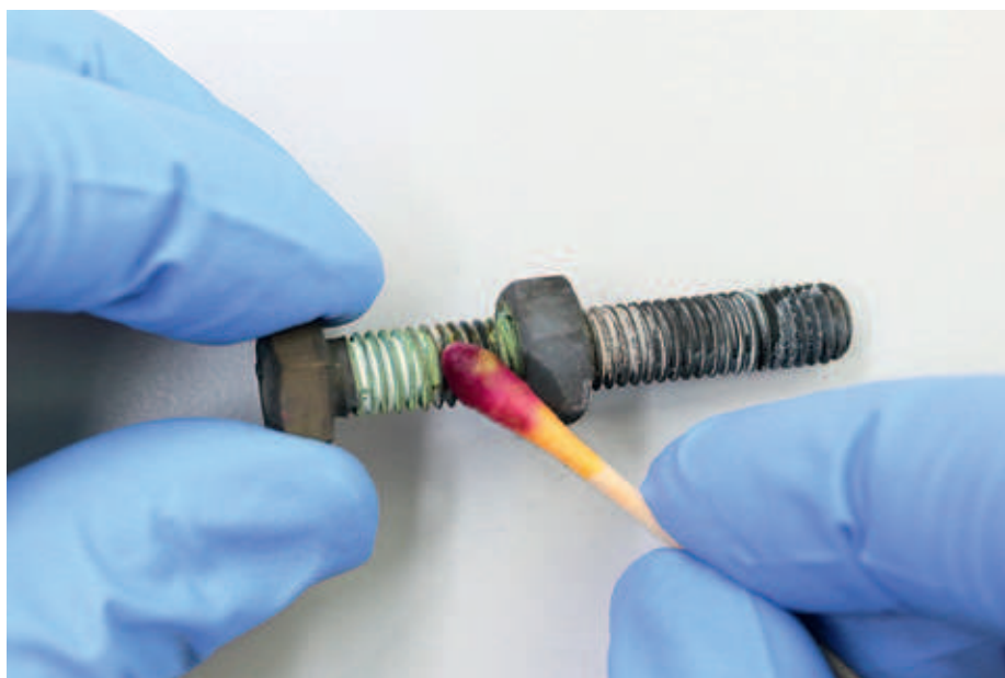
▲ Figuur 2. Voorbeeld van een RVS 304 (A2) bout en moer met anti-vastloopp middel na warmtebehandeling. Het gevormde gelige chromaat is duidelijk zichtbaar. De TKI I® chrom-6 detectie teststaaf verkleurt duidelijk rood/paars, wat erop duidt dat er chrom-6 aanwezig is.
