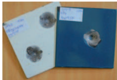
Figuur 3: Emallagen op RVS met aanvaardbare hechting. Het RVS werd behandeld met een primer, maar werd niet opgeruwd
