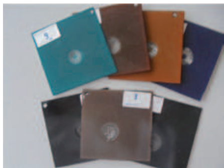
Figuur 1: Voorbeelden van gekleurde emallagen op stalen plaatjes dat eerst met een primer behandeld werd. De hechting is bepaald met de impacttest
