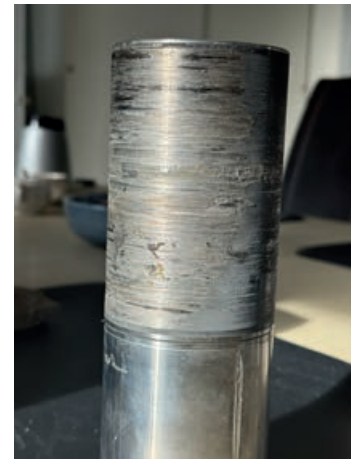
Slijtage van een pompas: Case met de te hoge viscositeit.
