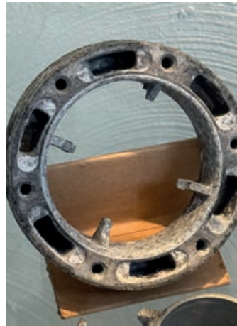
Breuk van een aluminium onderdeel: ontwerp- en gietfouten.
