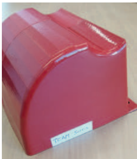
▲ Figuur 3: a) Testproduct, deels voorzien van een primer coating en nabehandeling met resulterende ruwheidswaarden, b) close-up van het oppervlak van de zijkant (primer + polijsten + topcoat)
