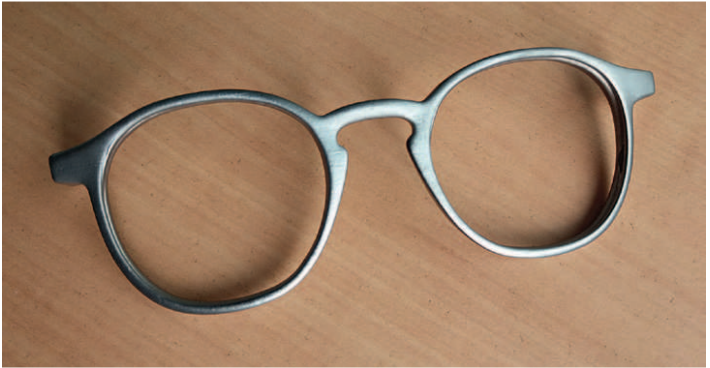
▲ Figuur 5: SLS-geprint brilmontuur afgewerkt via trillend slijpen en een primer om het oppervlak glad te maken. De eindlaag is een metallische PVD-coating.
