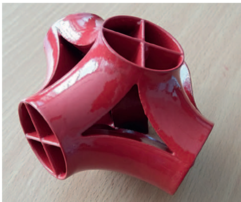
▲ Figuur 4: a) SLS-geprint stuk, b) primer coating elimineert de oppervlakteruwheid, c) finaal stuk met topcoat
