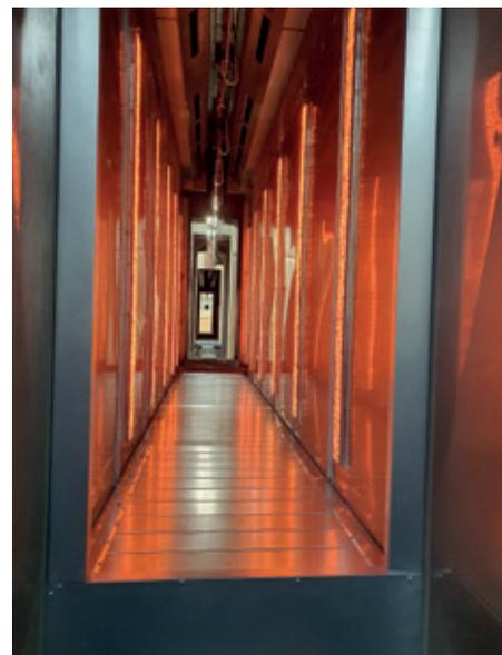
quelques secondes s'adapte parfaitement aux contraintes des lignes de peinture avec une durée de vie très longue, une bonne contrôlabilité de la puissance et un très faible niveau de maintenance. ■
