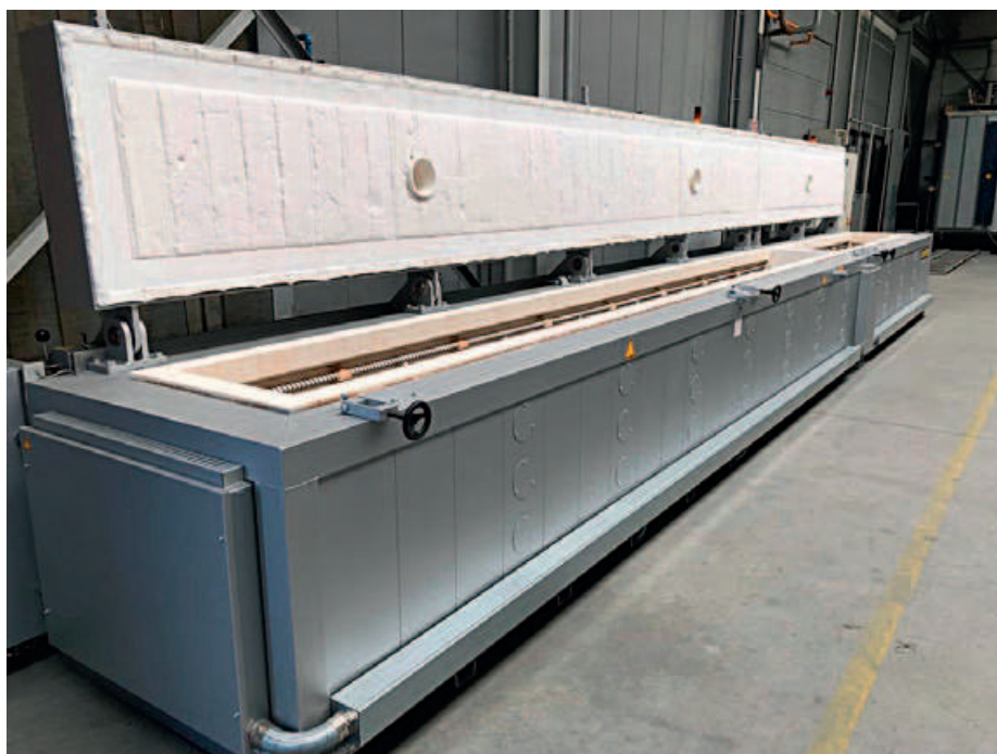
De nieuwe installatie waarin stukken tot 9 m behandeld kunnen worden.
