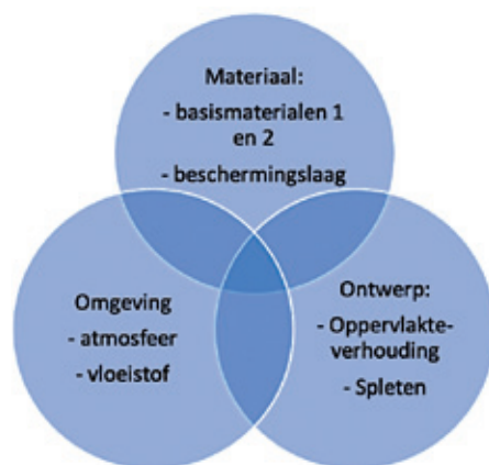
Het risico op galvanische corrosie wordt bepaald door het volledige systeem: materiaalkeuze, ontwerp en omgeving. Enkele mogelijke parameters worden in deze schematische figuur opgelijst.
